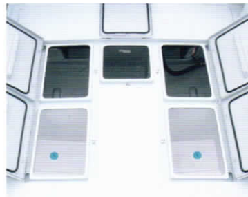
イケス&物入れ&プロペラ点検窓
