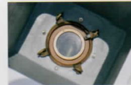
プロペラ点検窓
