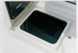
エンジンルーム出入口ハッチ[アフト]
