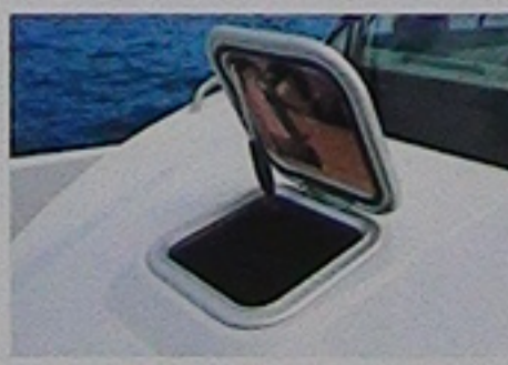
スカイライトハッチ【バース】
