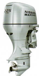
BF 225A 225ps(165.5kW) / 3,471cm 3 / 4ストローク / 水冷V型6気筒
