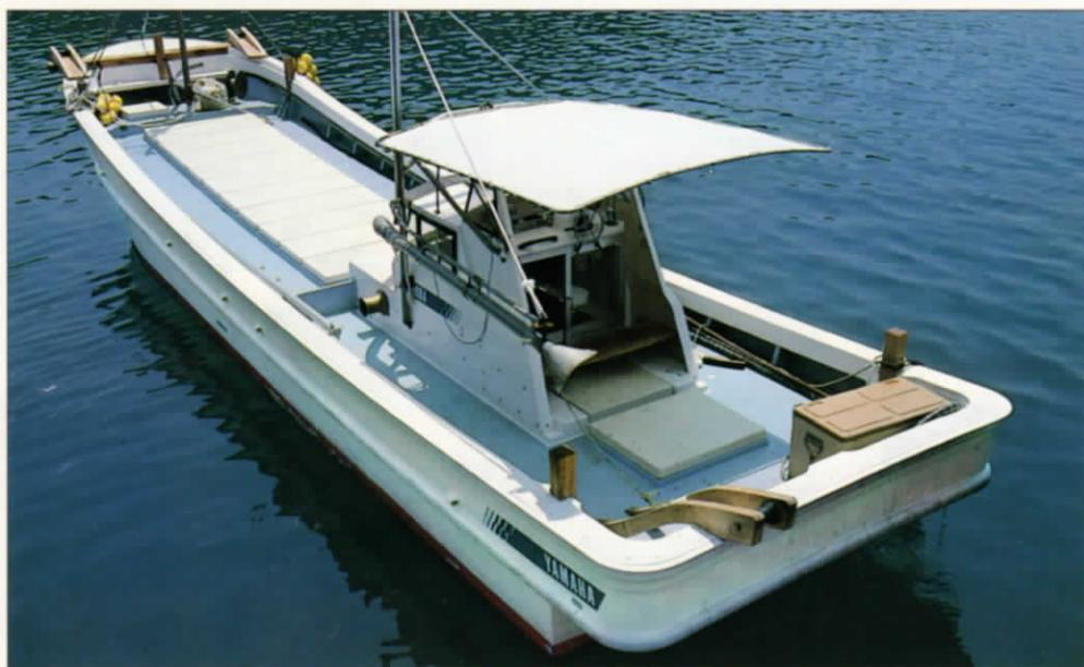
**充分な積載能力を実現** 養殖・投餌作業船としての積載性を十分に確保。魚倉容積15m<sup>3</sup>、餌積載量約13<sup>3</sup>、万全な荷受け能力をもたせた船体設計です。また、積載時のトリム変化を少なくするため、エンジンルームを後方に設置し、優れた荷重バランスを実現しています。
