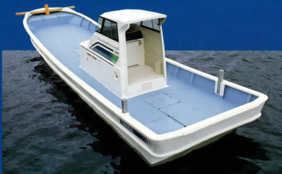
養殖作業に適した機能と性能を41尺の船体に凝縮しました。凌波性と追波性能、舵効き性能を高めた船型に、高出力エンジンを搭載可能とし、優れたスピード性能と安定性を両立。さらに、350ℓ×2と余裕の燃料タンクにより、長時間の走行に応えています。デッキは広いだけでなく、養殖作業を十分考慮したレイアウトが施され、現地儀装を容易にするトライ型マスト設置用凹部スペースなど、作業性を向上させています。その他、視認性に優れた大型旋回窓や各種航海計器の取付けを考慮したダッシュパネルなど、充実装備を斬新なデザインのブリッジに満載。東北の採介養殖のために生まれた一艇です。
