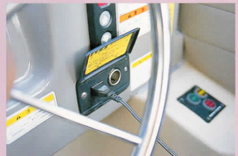
バッテリーから12Vと100Vの家庭用電源を採れるマルチアウトレット。(opt.)
