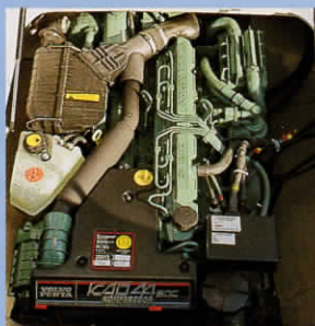
260PS(169.2kw)の高出力ディーゼルエンジンKAD44P/DP-E。
