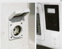
陸電/コンセント
