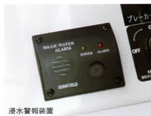
浸水警報装置
