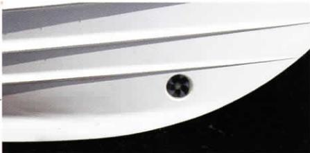
従来の1軸艇では桟橋への離岸や着岸は神経を使うものですが、パウスラスター(工場オプション)を装着すれば、より小回りのきくコントロールが可能になります。それにより、取り回しが楽になり、スムーズな離着岸や方向修正が実現します。離着岸や混雑した水域での微妙なコントロールをサポートします。
