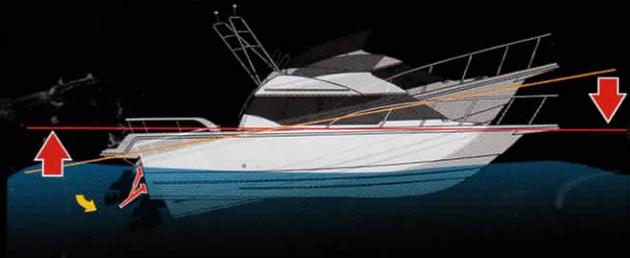
ヒール角を自動制御し船を最適な状態に保ちます。
