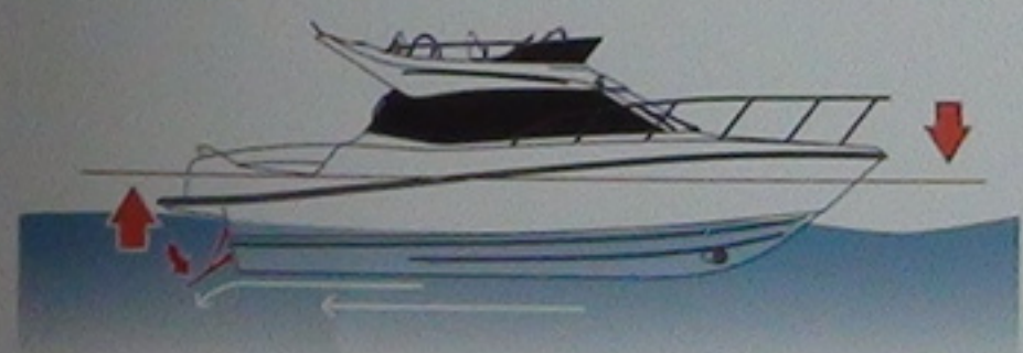
水流の抵抗を受ける様にフラップが下り、船体を最適な状態に自動調整
