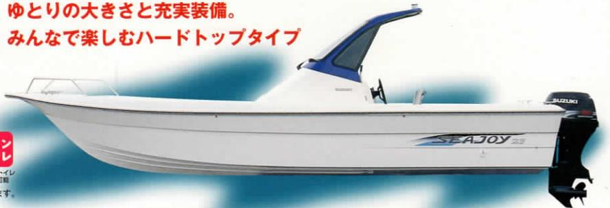
【SEAJOY 23HT主要諸元】 ●搭載船外機：4ストロークDF70TL (70馬力) ●全長：7.14m ●全幅：2.19m ●深さ：0.95m ●高さ：2.18m ●艇体重量：630kg ●定員：7名 ●航行区域：限定沿海
