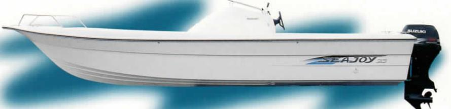
【SEAJOY 23主要諸元】 ●搭載船外機：4ストロークDF70TL (70馬力) ●全長：7.14m ●全幅：2.19m ●深さ：0.95m ●高さ：1.54m ●艇体重量：610kg ●定員：7名 ●航行区域：限定沿海
