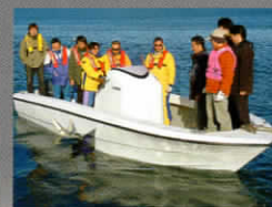
穴を開けたBAYSPO RTS 21の船体に10人が乗った浮力実験
