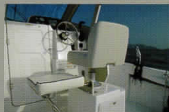
● ドライブシートセット(26) (油圧ダンパー回転式)
