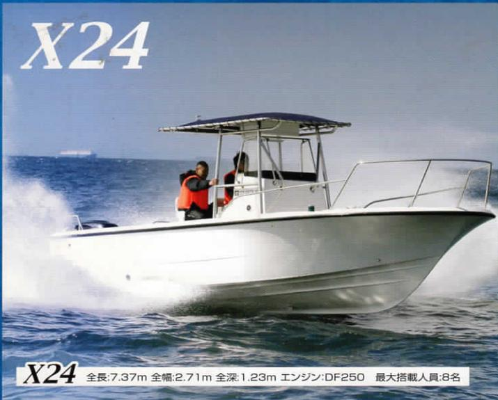
**X24** 全長:7.37m 全幅:2.71m 全深:1.23m エンジン:DF250 最大搭載人員:8名
