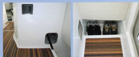
デッキシューズなどがおけるブーツロッカーと簡易的にロッドを収納しておける長尺ロッカーをキャビン入口に用意しました。
