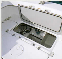
舵機室・プロペラ点検口
