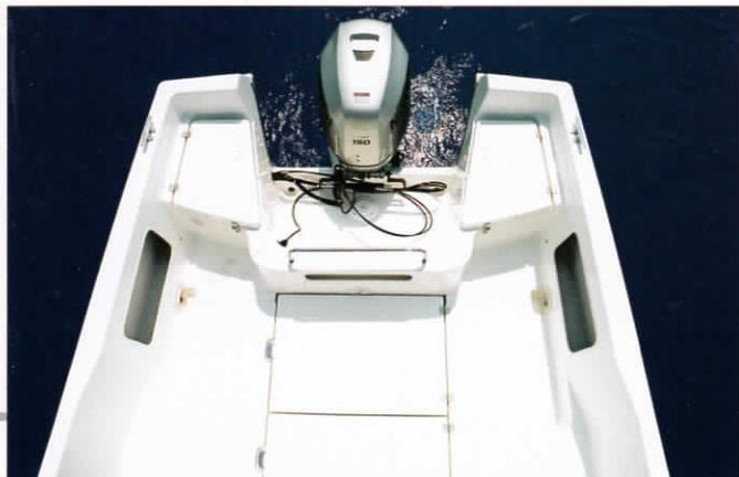
船外機の側面まで張り出したスポンソナルの採用によりスペース効率抜群のリアデッキ。気持ち良く竿を振れる余裕の広さを確保しています。
