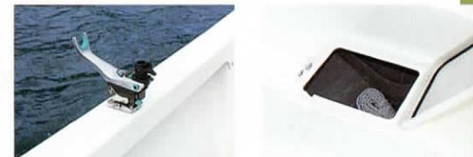
●オープンガンネル (図②) ※艀装例 ●ロープロッカー (図③)
